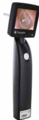
Capture d'écran par simple pression sur l'interrupteur marche/arrêt.
